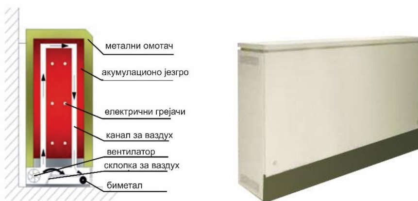
Слика 7.8: Изглед термоакумулационе пећи
