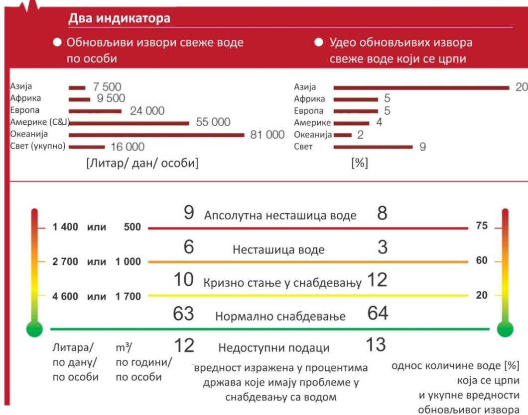
Слика 11.3: Утицај јединичне потрошње воде у спрези са расположивим ресурсима на начин снабдевања водом [4]
